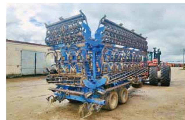
Предпосевные комбинаторы Farnet Kompaktomat предназначены для подготовки поля после вспашки и обработки почвы. Прекрасно выравнивают поверхность, измельчают комья земли, помогают образовать оптимально уплотненное посевное ложе
